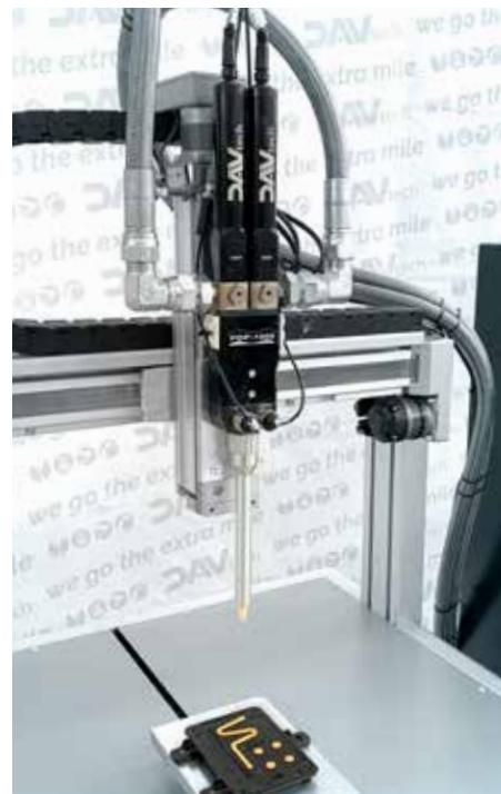
Le pompe PDP rivoluzionano il concetto di precisione nella dosatura di fluidi bicomponenti. La **centralizzazione dei processi di proporzionatura e miscelazione in un unico device** permette risultati irraggiungibili da sistemi a pistoni o di altro tipo.
