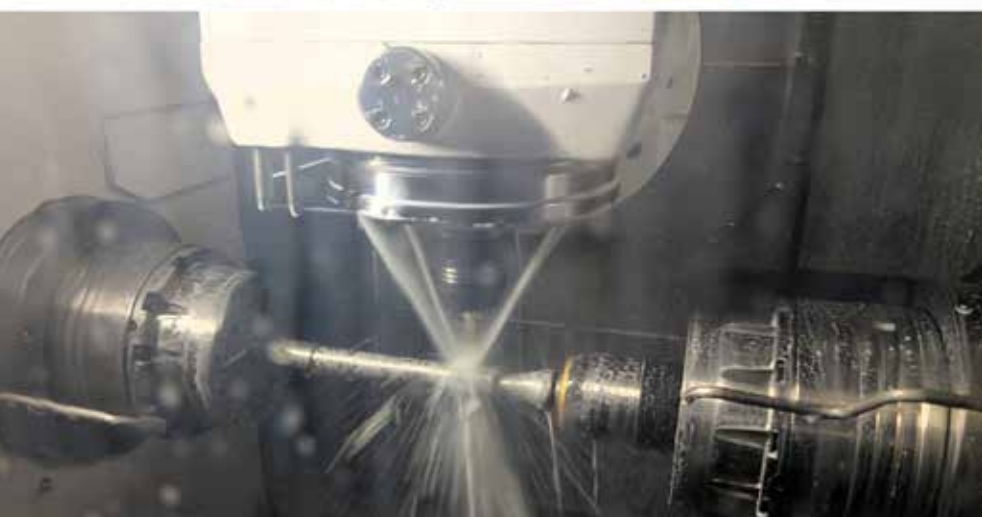
Hainbuch System, per un rapido passaggio da un bloccaggio esterno a uno interno.
