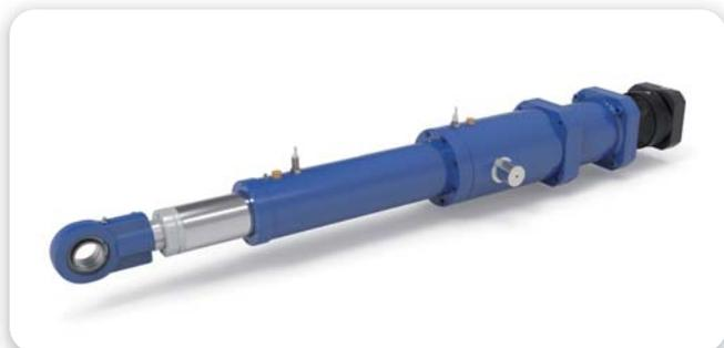
Disponibile in sei grandezze, con montaggio motore in linea o parallelo, riduttore epicicloidale di precisione, con integrazione per servomotori e fissaggi standard ISO 8132 relativo ai cilindri idraulici, per una totale e semplice intercambiabilità.
