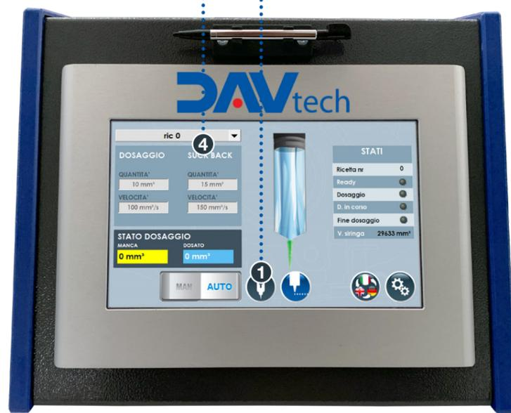
**5** Sistema di dispensazione volumetrica di prodotti in siringhe pre-caricate, come: colle cianoacriliche, paste saldanti, resine fornite in siringhe congelate, fluidi abrasivi o reattivi.
